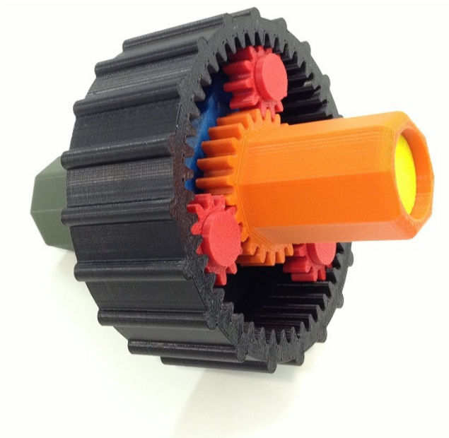
Kuva 12. Esimerkki tulostamalla valmistetusta pikaprototyypistä. (Aipworks 2014.)
