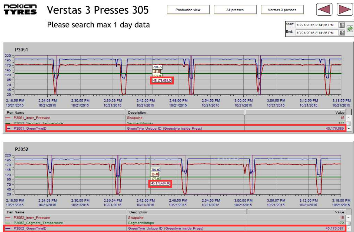
KUVA 10. Kuvakaappaus renkaan jäljitettävyystiedoista Proficyssä (Nokian Renkaat Oyj 2015d)
