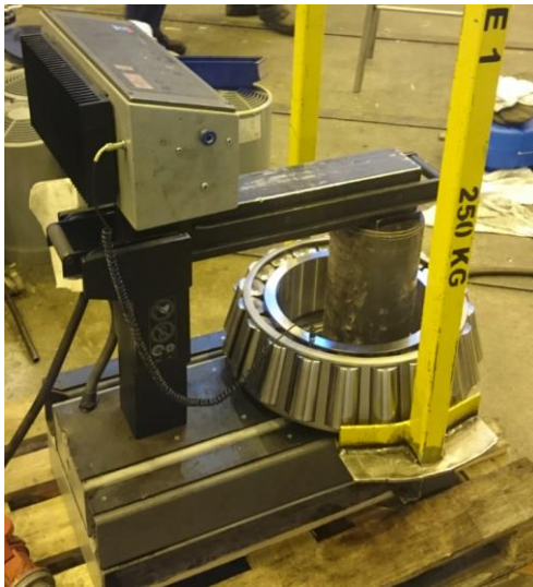
KUVA 10. Induktiolämmitin ja laakeri
