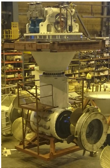
KUVA 20. Potkurilaite on yhdistettynä ja jarrut paikallaan.
