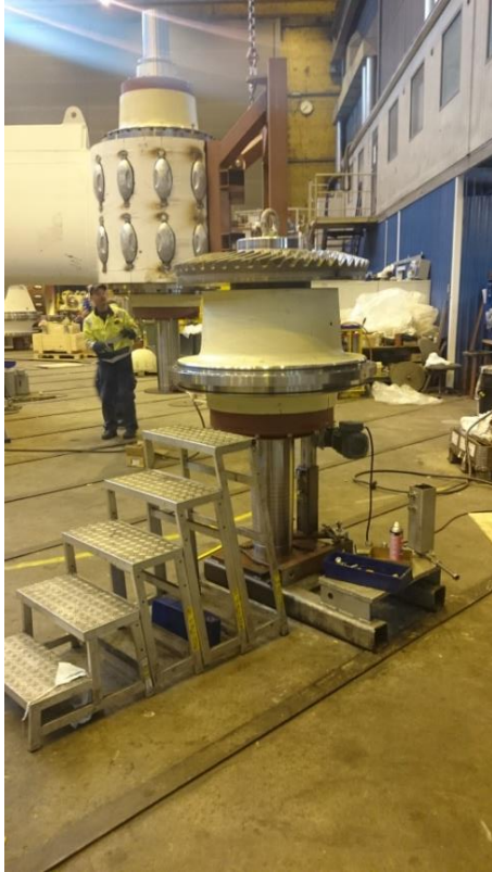
KUVA 19. Laakerien esisäätöpukki, jossa laakeripesä on paikallaan
