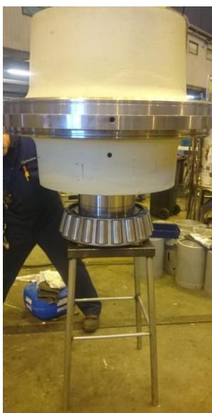
KUVA 18. Laakerin asennus akselille ja laakeripesään
