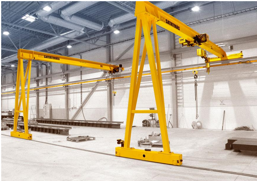
KUVA 23 Siltanosturit, joissa toinen pää kulkee lattian kiskolla ja toinen seinän kiskolla (Satateräs Oy. kuvagalleria 2015)
