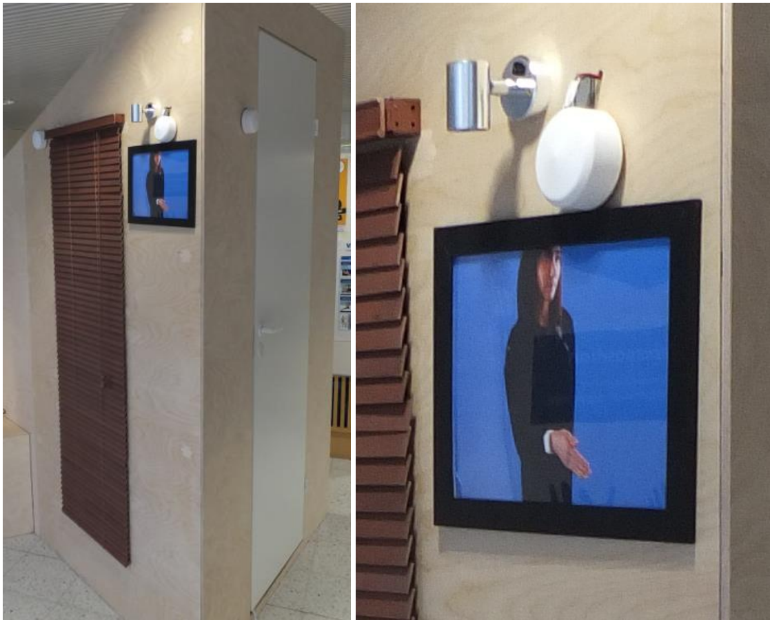
Kuvio 4. Eleohjaimen esittely-ympäristö. Vasemmassa kuvassa on kokonaisuus, jossa on vastaanottimet sälekaihtimien, kohdevalon ja oven ohjaamiseen. Rajauksen ulkopuolelle vasemmalle jää TV-taso. Oikeassa kuvassa on suurennos kohdevalon vastaanottimesta.
