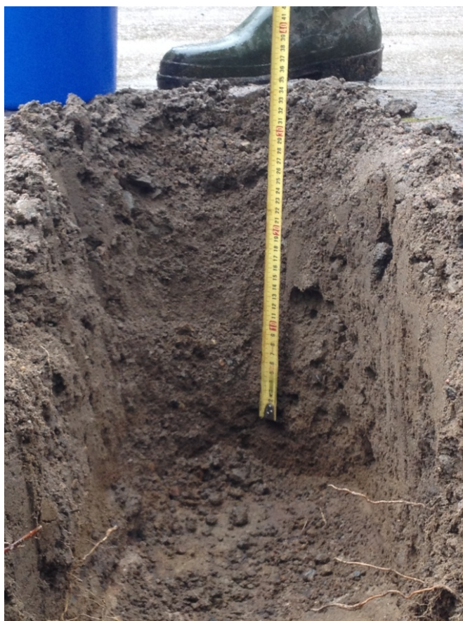
Kuva 8. Koekuopassa mittanauhan alareuna on silmämääräisen kivimurskaimella tehdyn rakenteen ja alla olevan rakenteen rajalla. (Rissanen 2015-05-26)
