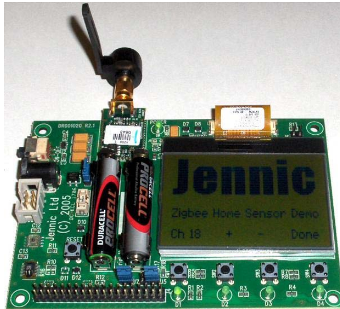
Kuva 4: Jennic koordinaattori, missä on kiinni M02 moduuli
