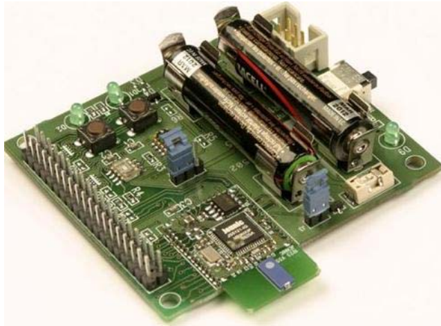
Kuva 5: Jennic RFD, missä kiinni M01 moduuli ( http://www.ed-china.com/ARTICLES/2006FEB/1/2006FEB01_ES_RFD_OT_275F1.JPG )
