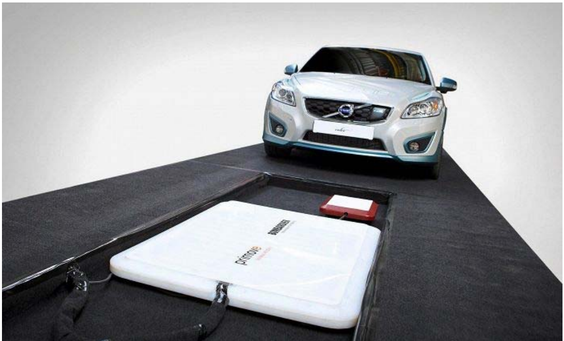
Kuva 1. Induktiolatauksessa auto ajetaan latauslaitteen päälle (Helsingin Sanomat 2015).
