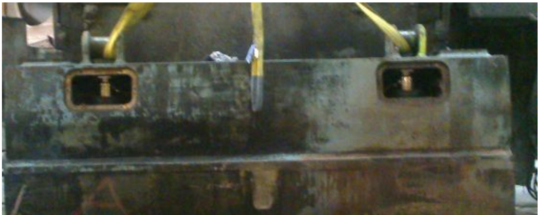
Kuva 15. Vaihdetut välialtaan vaaka-anturit.
