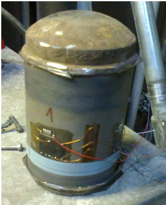
Kuva 2. Punnitusanturista on poistettu metallinen sisäkuori
