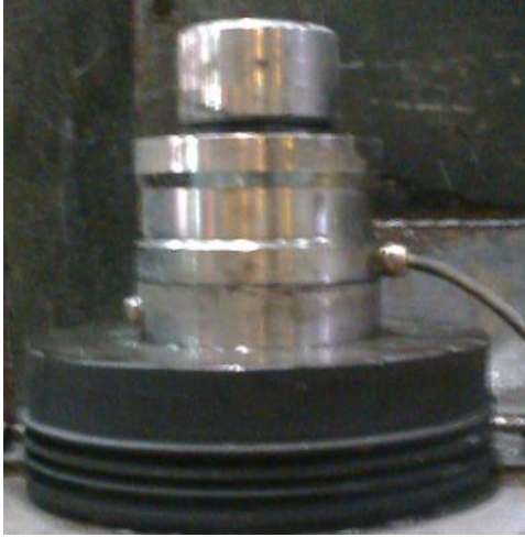
Kuva 5. 100 t RTN-tyyppinen punnitusanturi (kuva on tehdasasennuksesta)
