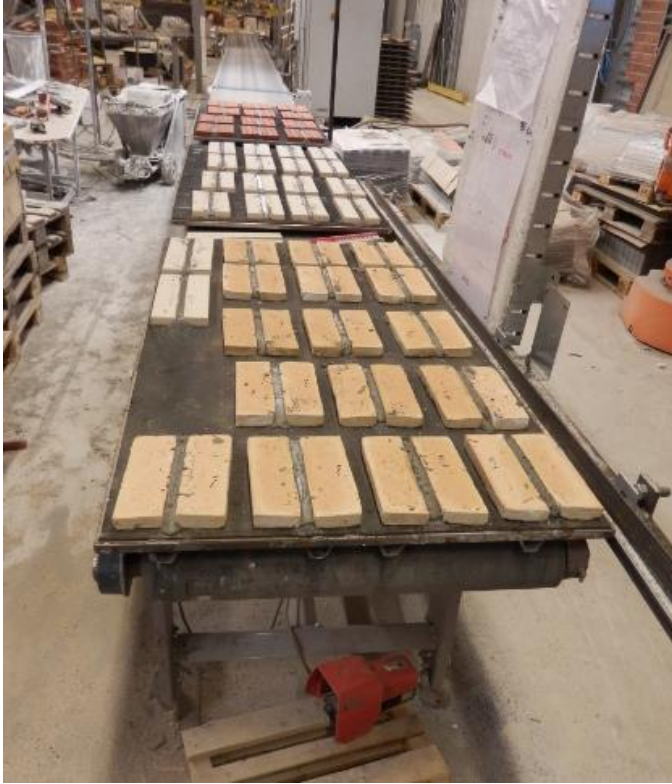
KUVA 13. Saumatut tiililaatat kuivumassa
