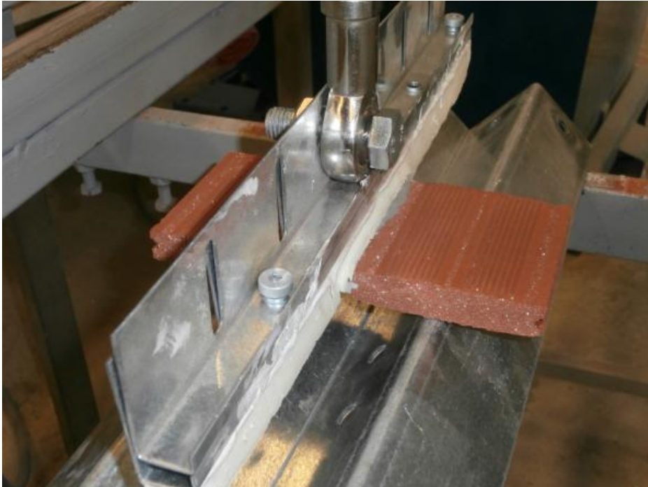
KUVA 10. Stofixin tartuntalujuuden testausmenetelmä
