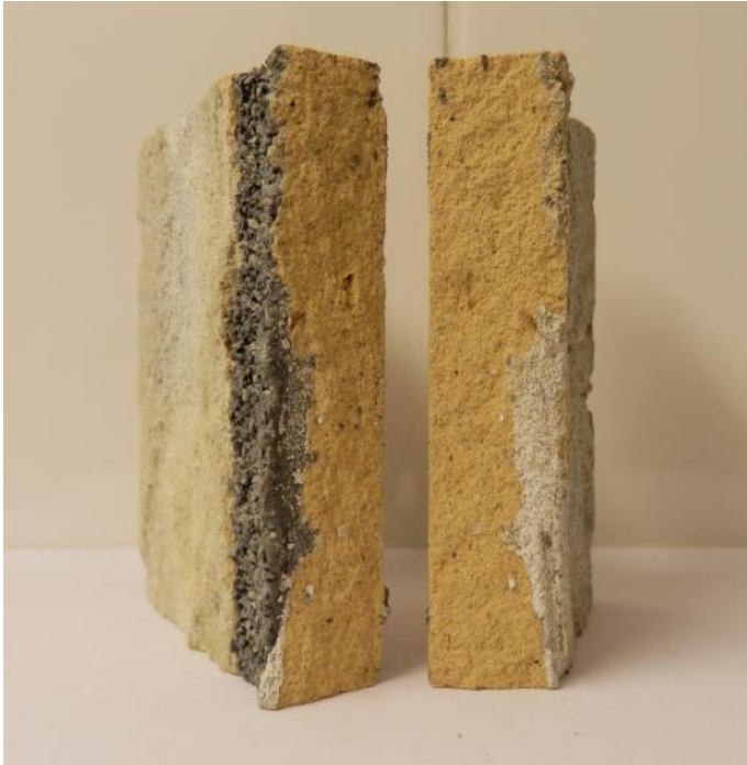
KUVA 20. Murtoon asti kuormitettu C-sarjan koekappale
