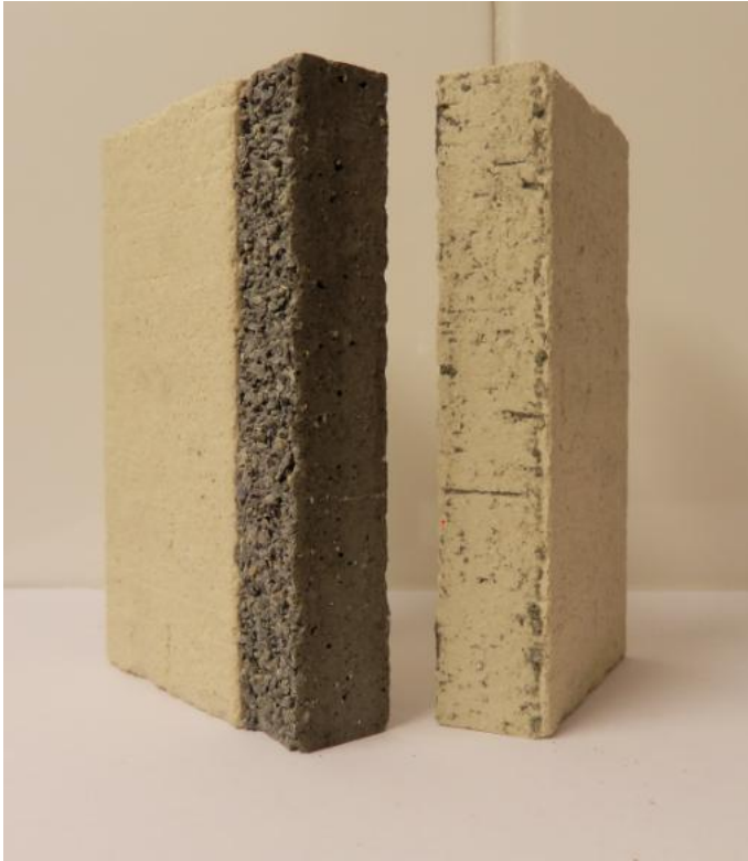
KUVA 18. Murtoon asti kuormitettu A-sarjan koekappale
