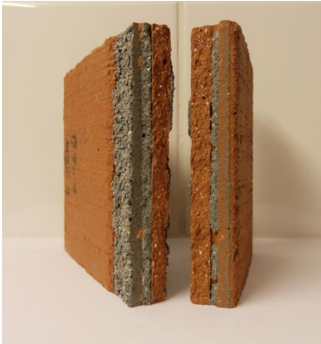
KUVA 19. Murtoon asti kuormitettu B-sarjan koekappale
