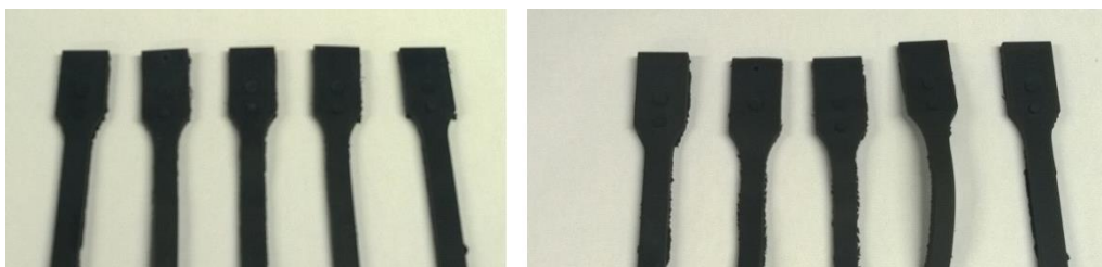
KUVIO 16. UV- vanhennetut SEBS- materiaalit: vasemmalla Lifoflex ja oikealla OnFlex.
