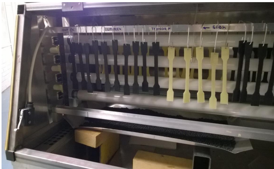
KUVIO 8. Koesauvat aseteltuna UV-kaappiin.
