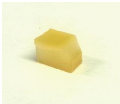
KUVIO 14. Flexalloy- materiaalista leikattu näyte.
