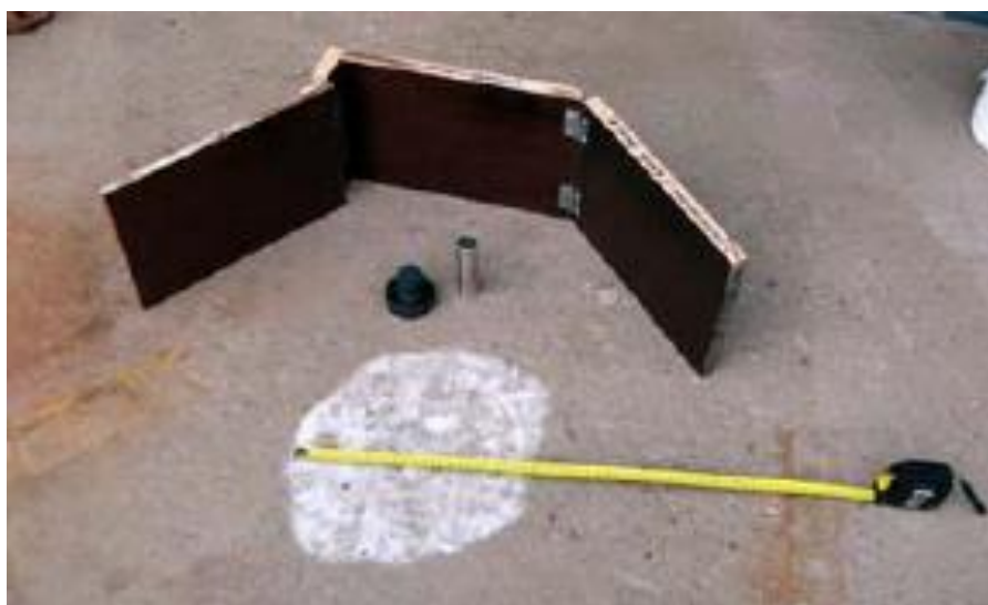
Kuva 10. Eristysalustan karheuden mittaus lasihelmien avulla.
