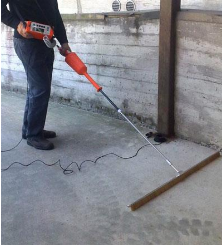
Kuva 13. Periaatekuva korkeajännitemenetelmällä mittaamisesta. (Kuva: www.pinteco.fi , © YTM-Industrial Oy / Pinteco).
