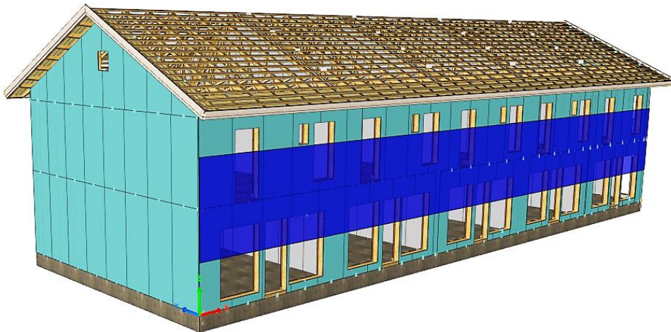
KUVA 45. Rakennuksen sivusta välipohjatasolle siirtyvä tuulikuorma
