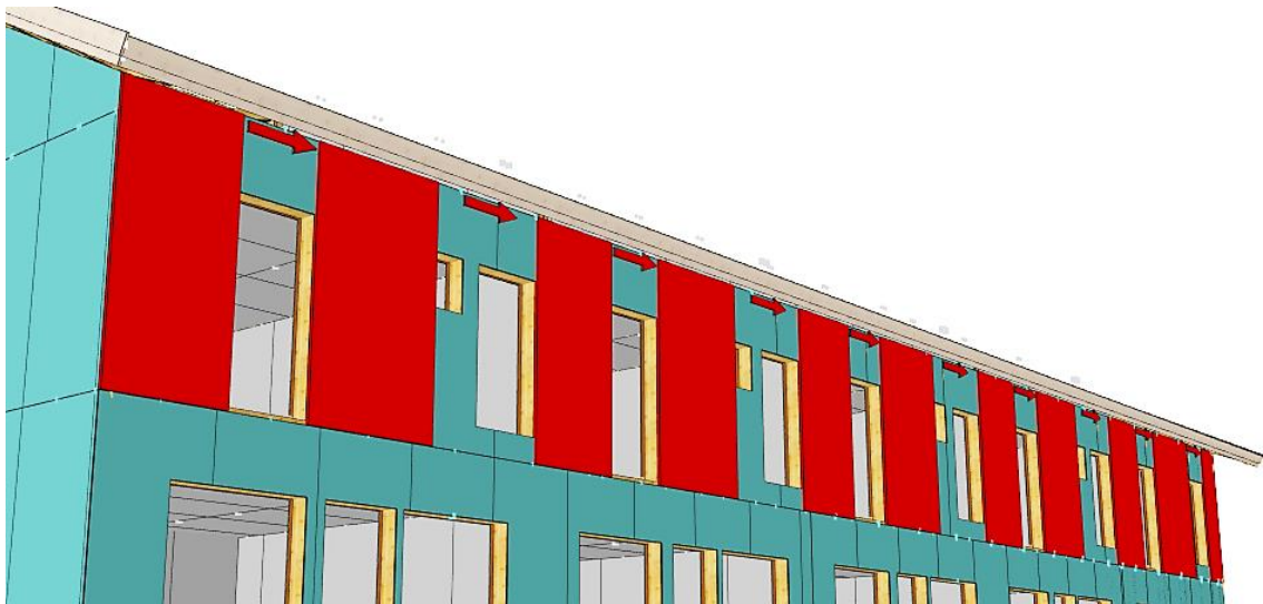
KUVA 40. Jäykistävät seinälohkot 2. kerroksen pituussuuntaisella ulkoseinällä
