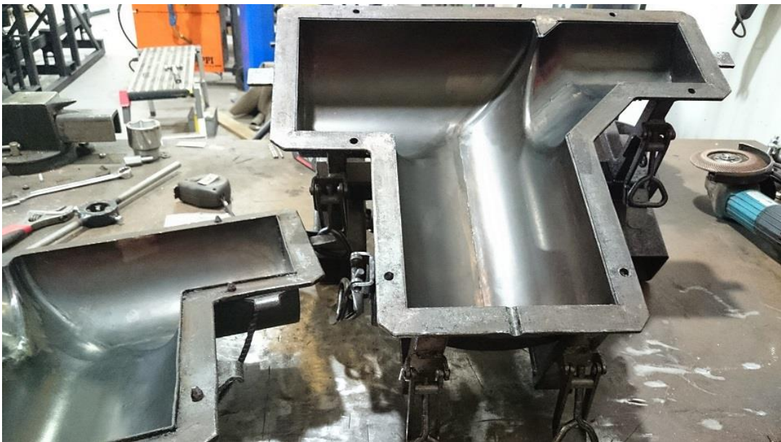
KUVA 5. Pellistä valmistettu muotti
