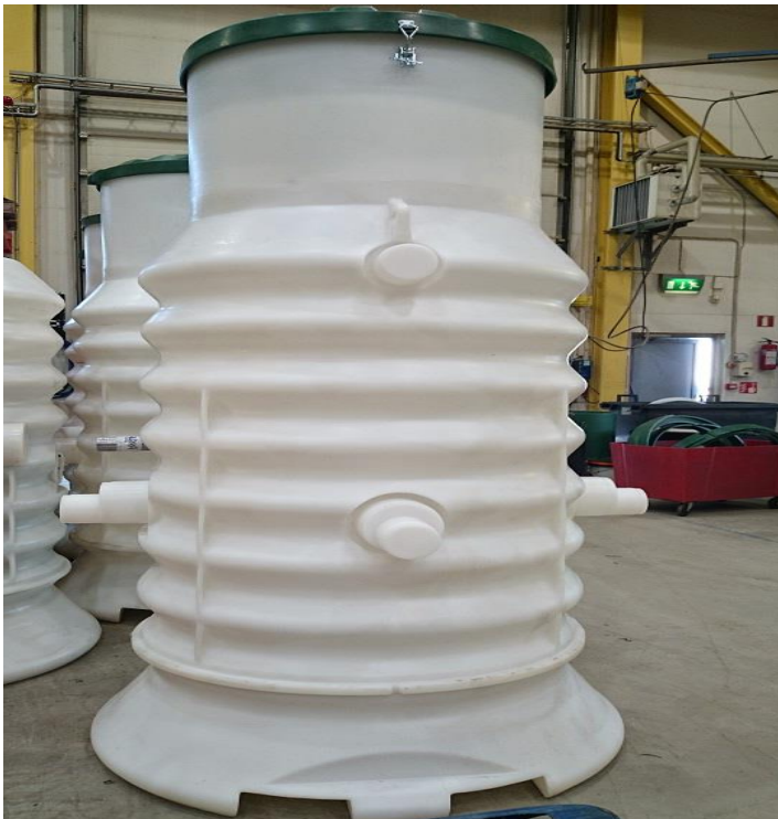
KUVA 4. Rotaatiovalumenetelmällä valmistettu pumppaamon aihio
