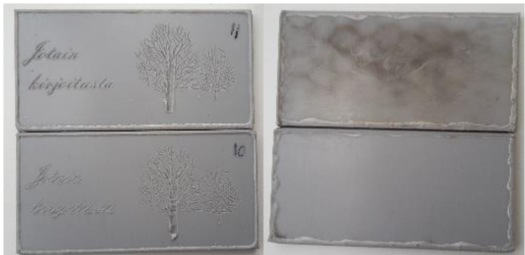
KUVIO 14. Polypropeenikappaleissa esiintyvää pursetta kuvioinnissa ja reunoilla.
