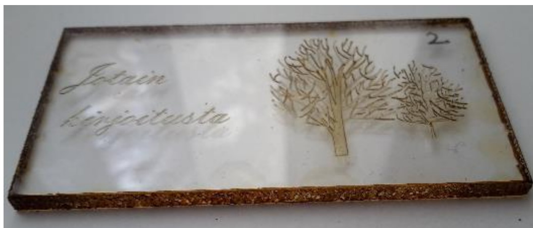
KUVIO 13. Laserleikattu polykarbonaatti kappale.
