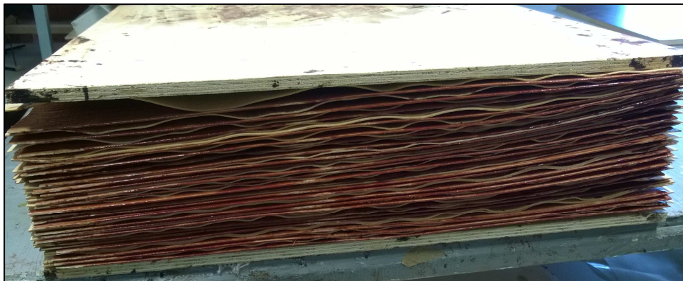
KUVIO 9. Esipuristusta odottava ladottu viilupinkka
