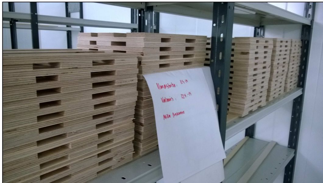
KUVIO 13. Sahatut koekappaleet tasaannutettiin ilmastointihuoneessa
