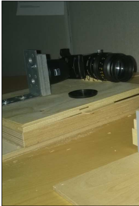
KUVIO 9. Lasersäteen vastaanottava kamera
