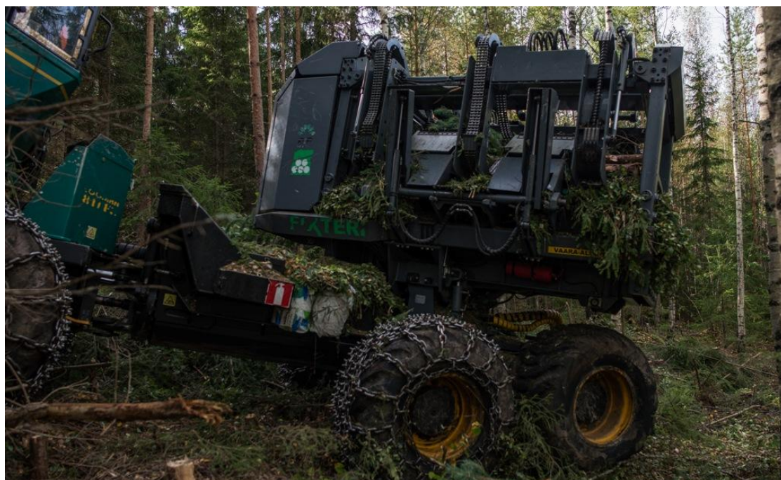
KUVA 2. Fixteri FX15a –kokopuupaalain. (Kuva: Kalle Pisto 2015)
