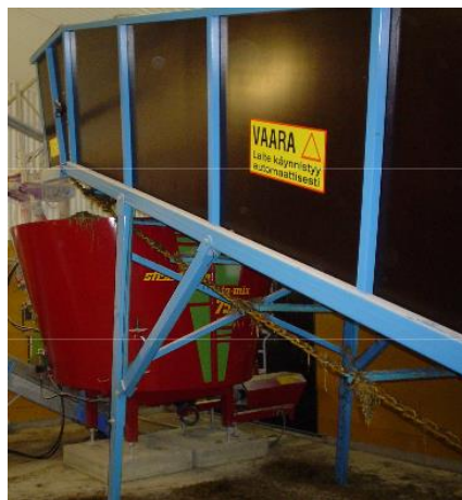
Kuva 6. Täyttöpöydällä voidaan täyttää mm. kiinteää seosrehuvaunua (Halonen & Manninen 2007).
