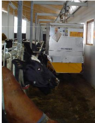
Kuva 8. Seosrehurobotti kulkee navetassa kattoon asennetuilla kiskoilla (Halonen & Manninen 2007).
