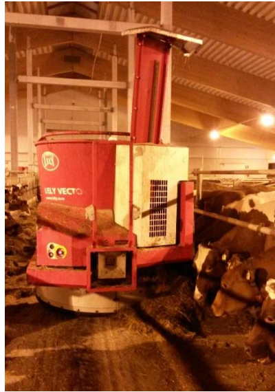
Kuva 9. Sekoitus- ja ruokintarobotti jakamassa seosrehua lehmille (Friman 2015).
