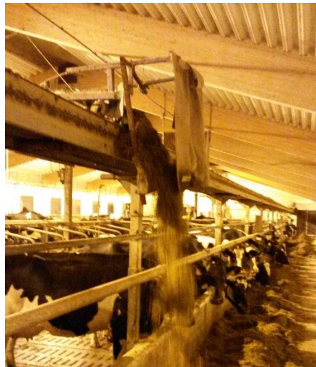
Kuva 7. Mattokuljettimen kelkka tiputtaa rehun eläinten eteen (Friman 2015).
