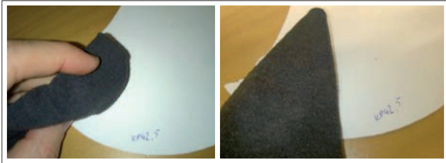
KUVA 22 ja 23. Painoalustaa (KP42) hangattiin mustalla kankaalla, kankaaseen ei tarttunut valkoista pölyä.
