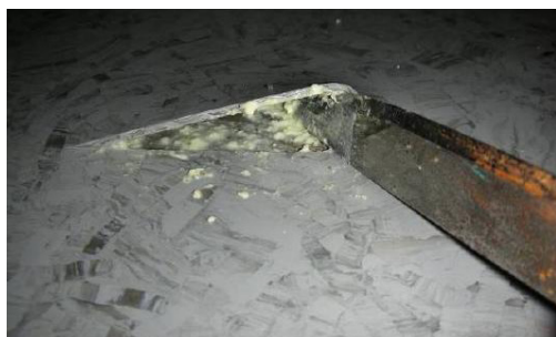
FIGUR 8. Alkalisk hydrolysis av lim (Keinänen, 2013).
