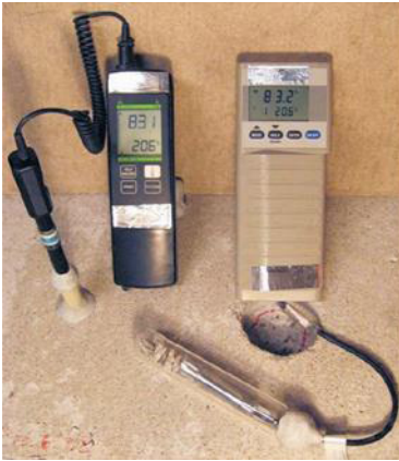
FIGUR 3 Mätinstrument för fukt- mätning i borrhål och på uttaget prov (RTS, 2010)
