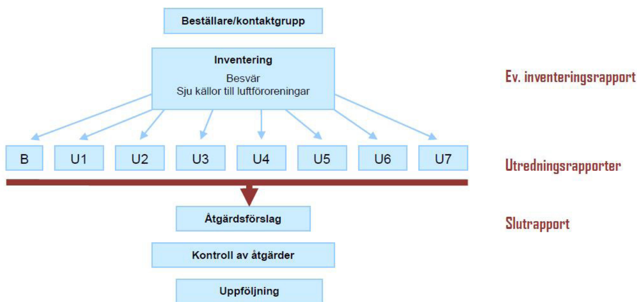
FIGUR 4. Flödesschema över metod för inomhusluftutredningar i Sverige.
