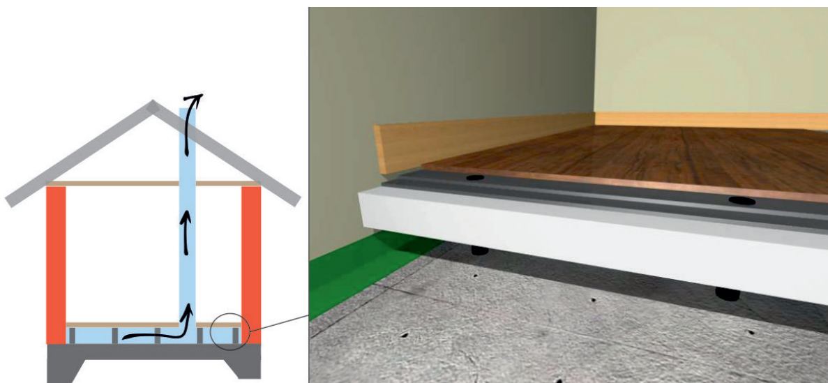
FIGUR 17. Mekaniskt ventilerat golv.
