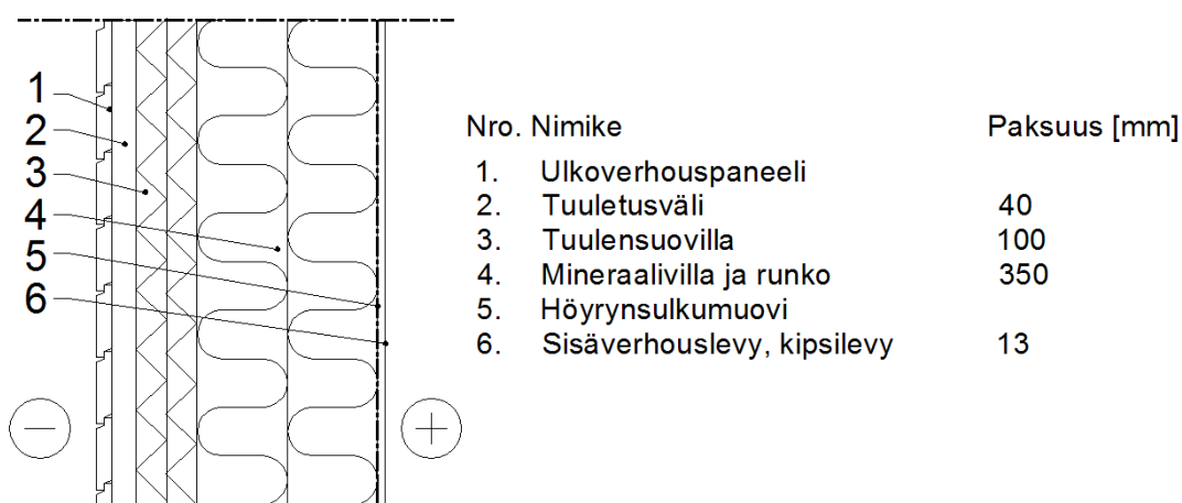
Piirros 6. Passiivitalon ulkoseinärakenne.
