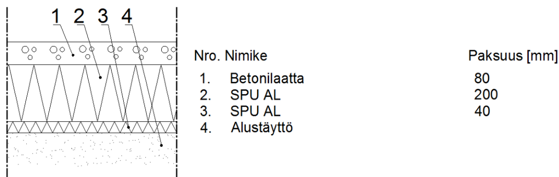
Piirros 4. Passiivitalon alapohjarakenne.
