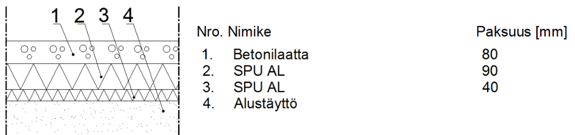
Piirros 1. Normitalon alapohjarakenne.
