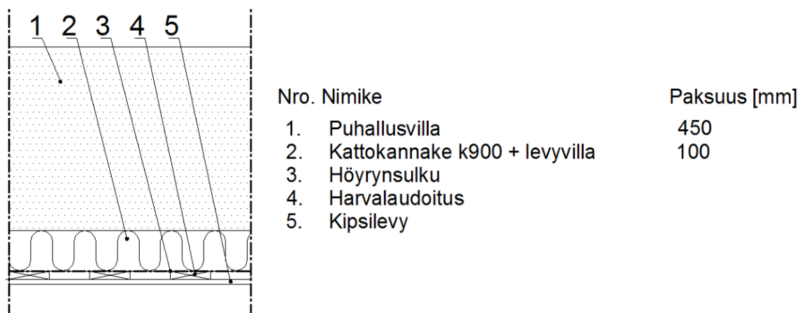
Piirros 5. Passiivitalon yläpohjarakenne.
