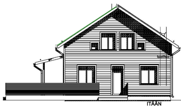
KUVA 20. Julkisivukuvista on helppo mitata esim. vesikaton pinta-ala reunojen pituuksien avulla
