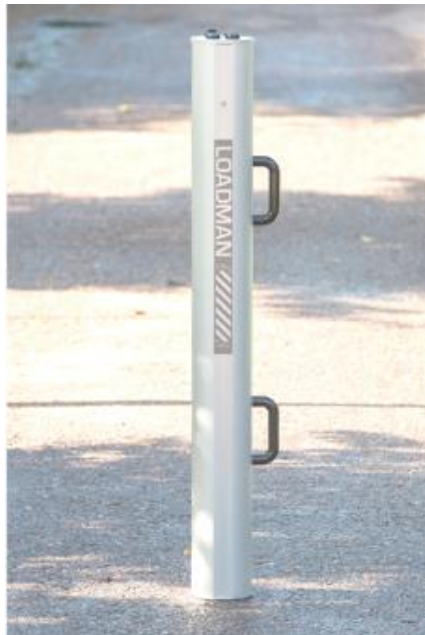
Kuva 5. Loadman-pudotuspainolaite. (AL-Engineering Oy 2015.)
