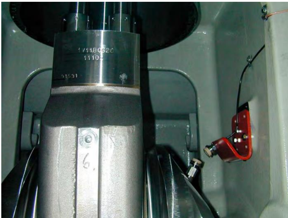
Kuva 15. Langaton kiertokangen laakerin lämpötilamittaus (Woodyard 2009.)
