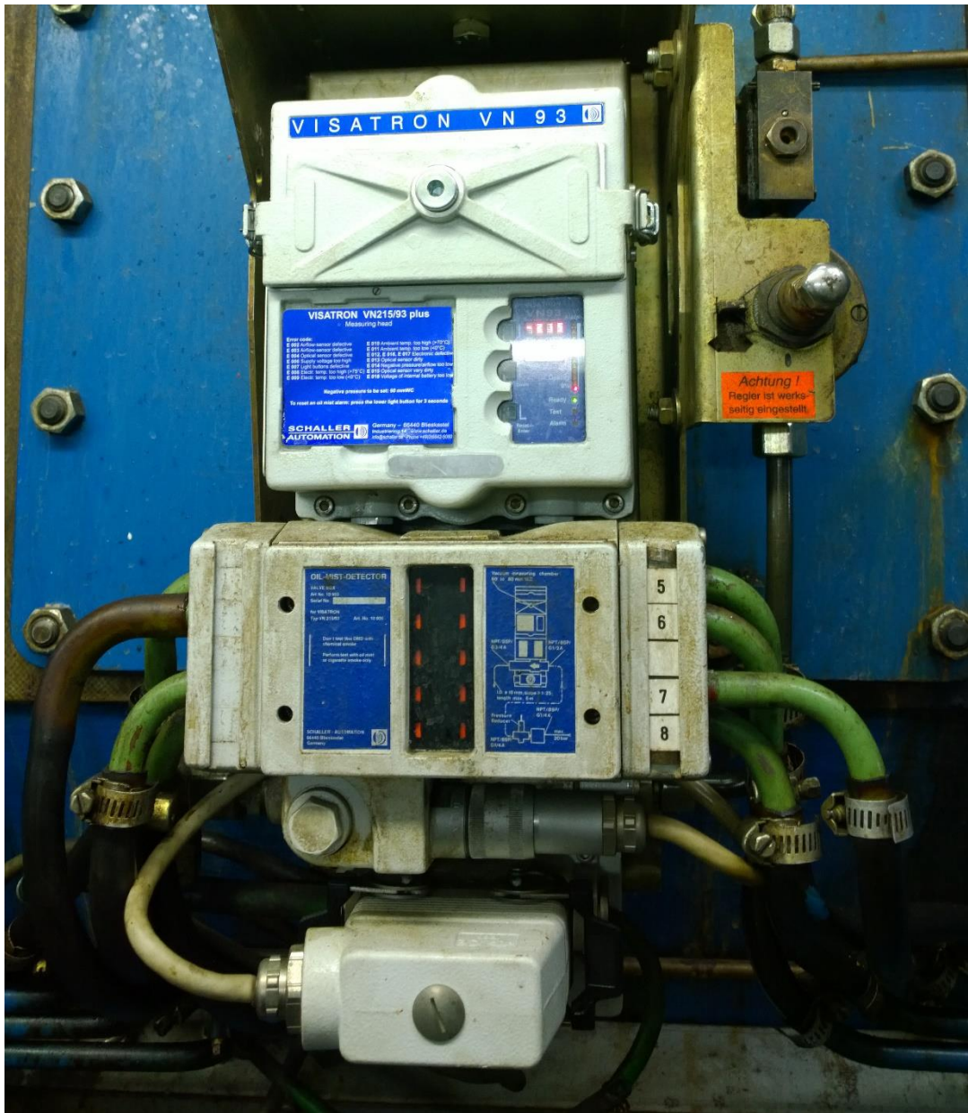
Kuva 8. Schaller VN 215 / 93 öljysumuvaroitin. (Stenman 2014.)
