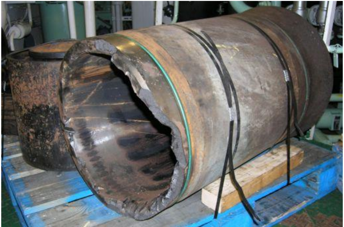
Kuva 6. Sulzer ZA40 sylinterivuori männän kiinnileikkautumisen ja öljysumuräjähdyksen jälkeen. (Marinediesels 2016.)
