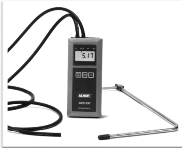
Kuva 7. Ilmamäärämittari AXD-530 Micromanometer (12).
