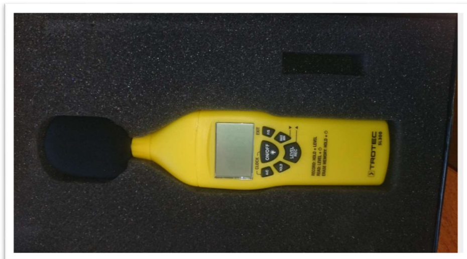
Kuva 8. Melutasmittari Trotec SL300.
