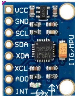
Kuva 18 GY-521 Gyro anturissa ovat signaalit ja virtasyötöt selkeästi merkityt (DX 2016a).
