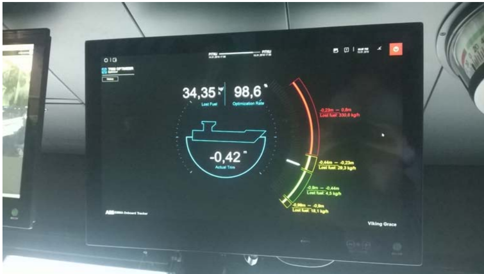
Kuva 5 m/s Grace:n EMMA Dynamic Trim Optimizer näyttö sillalla.
