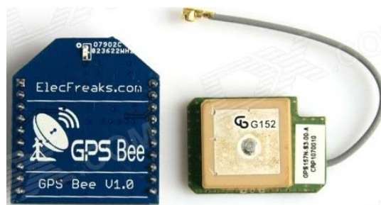
Kuva 19 ElektroFreaks'in GPS-anturi ja keraaminen antenni (DX 2016b).
