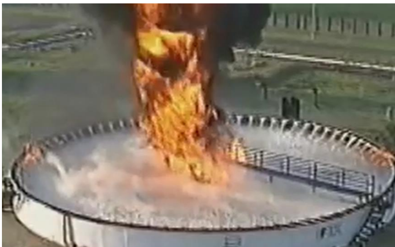
Kuvio 7. Öljytankkipalon sammutustesti tankin vaahtotuksella
