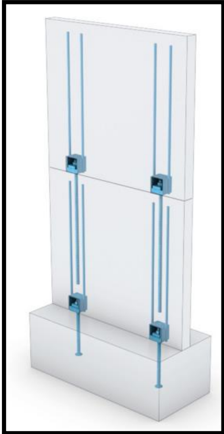
Kuva 8. Seinäkenkä ja jatkospulttiliitos (9)
