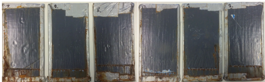
Kuva 2. Alkydipintamaalin päälle maalatut Isotrol –maalauksjärjestelmällä maalatut testilevyt. Vasemmalla on kolme 1440 tunnin ja oikealla kolme 480 tunnin suolasumukokeessa ja viiltokokeessa olleet testilevyt.
