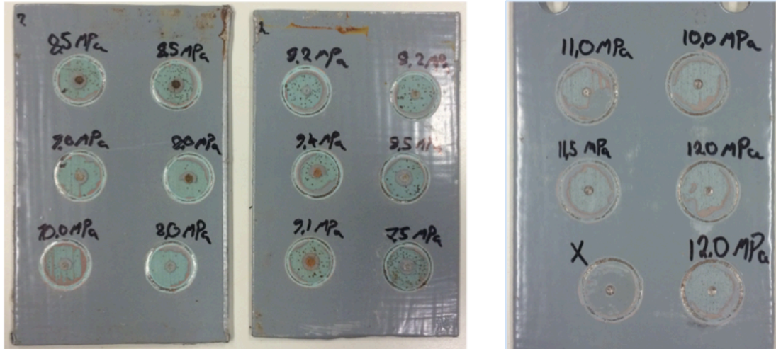
Kuva 1. Referenssilevyjen (Tiel 4.9 –maalausjärjestelmä St 2 –puhdistuksella) tartuntatulokset. Oikealla on kuivatartunnan vetokoetulokset ja vasemmalla on kahden rinnakkaislevyn märkätartunnan vetokoetulokset.
