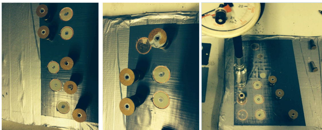
Kuva 6. Sillan palasen pintamaalipinnalle Isotrol -maalusjärjestelmällä maalattujen testialueiden vetokokeen murtumapinnat. Oikealla on kuivatartunnan vetokokeen murtumapinnat ja vasemmalla on kahden rinnakkaisalueen märkätartunnan vetokokeen murtumapinnat.
