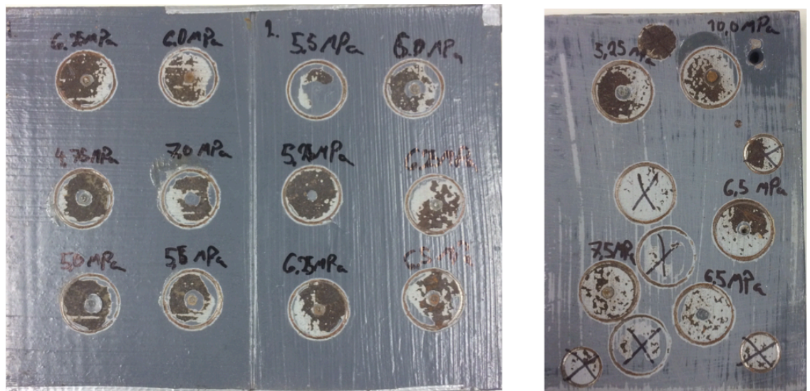
Kuva 4. Wa 2 –puhdistettujen ja Isotrol –maalaujärjestelmällä maalattujen testilevyjen vetokoetulokset. Oikealla on kuivatartunnan vetokoetulokset ja vasemmalla on kahden rinnakkaislevyn märkätartunnan vetokoetulokset.
