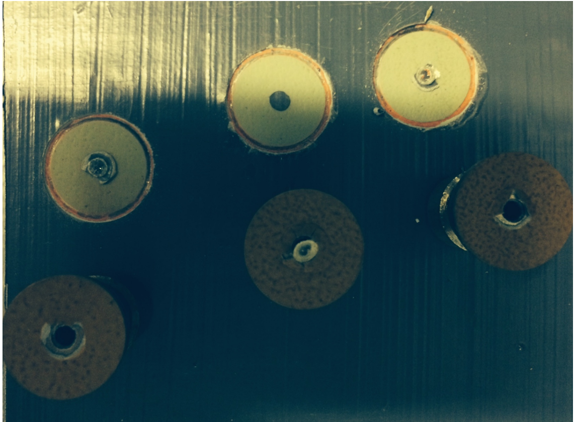
Kuva 13. Isotrol -maalauksjärjestelmän märkätartuntamittauksen tulokset, kun lyijymönjä-järjestelmä oli tartunta-alustana.
