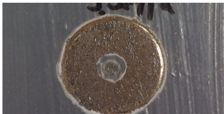
Kuva 12. Isotrol –maalauksjärjestelmän irtivetokoetulos.
