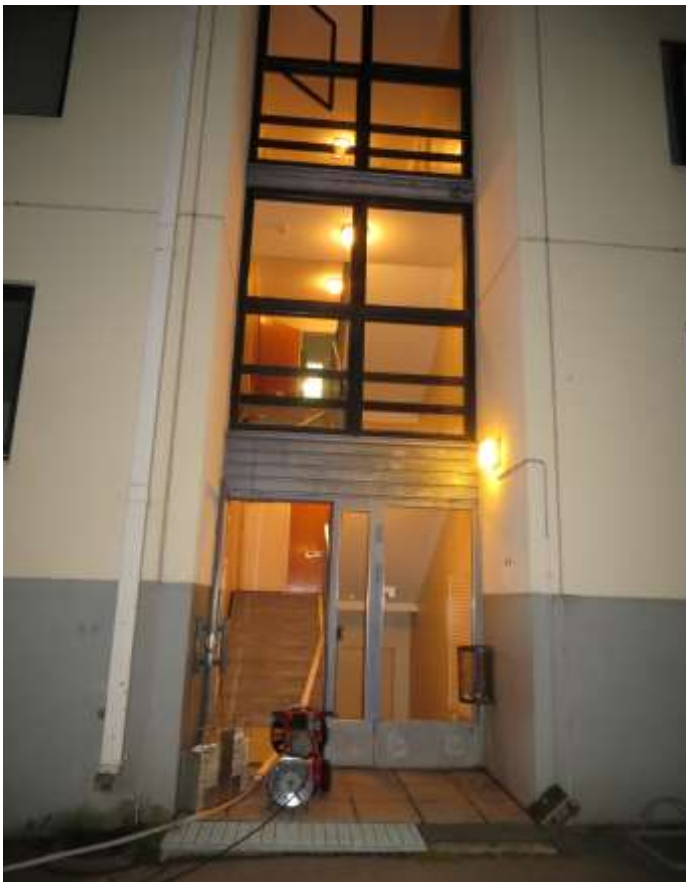
Bild 9. Vädring av trappuppgång med fläkt efter en lägenhetsbrand. Foto LUP
