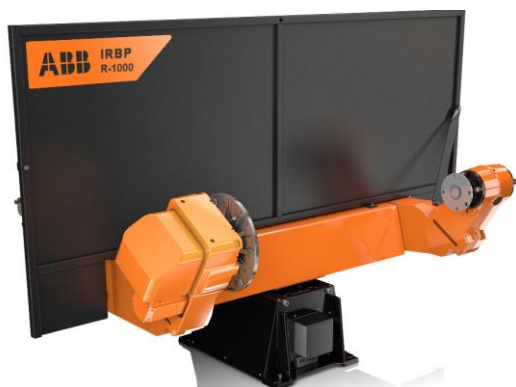
Figur 5. Rotation med avskiljningsvägg. (ABB, u.å.)
