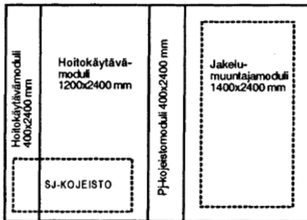
KUVA 2. Esimerkki puistomuuntamon pohjapiirroksesta (ABB, TTT-käsikirja)
