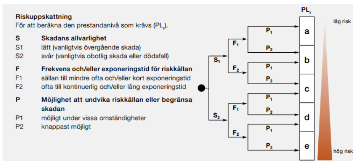
Figur 11. Diagram för att bestämma PL r enligt EN ISO 13849-1.
