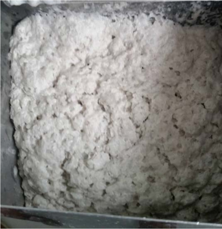
KUVA 24. Vaahdotuskokeiden A2 ja B2 vaaleanharmaa rikastevaahto
