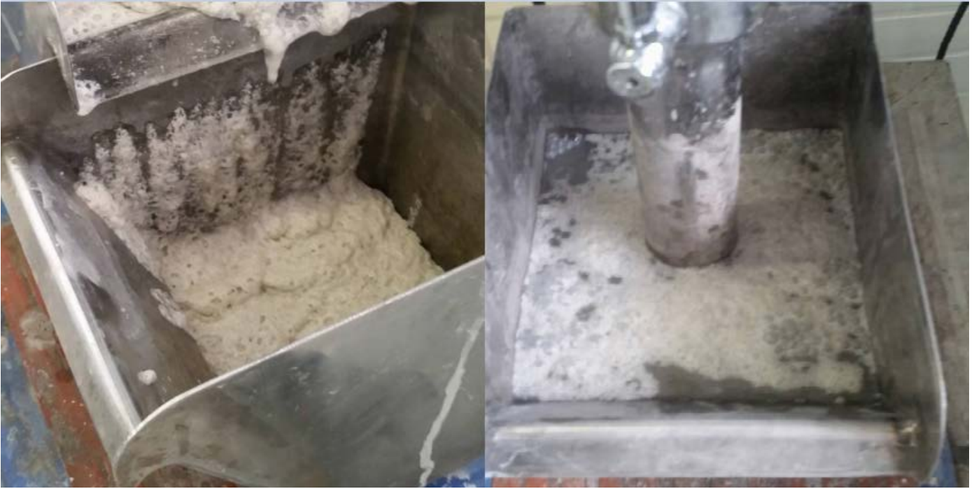
KUVA 26. Kokeessa B4 syntynyt tummanharmaa rikastevaahto ja vaahdotuksen aikana näkyviin ilmestynyt kennon veden pinta
