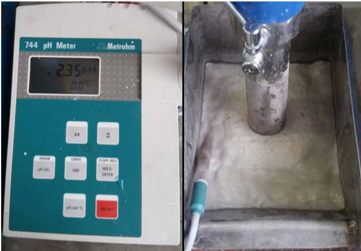
KUVA 23. Lietteen pH:n säädössä käytetty kalibroitu pH-mittari
