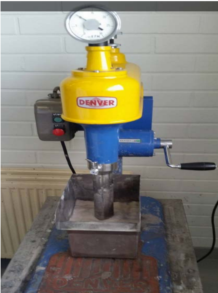
KUVA 22. Vaahdotuskokeissa käytetty Denver-kenno
