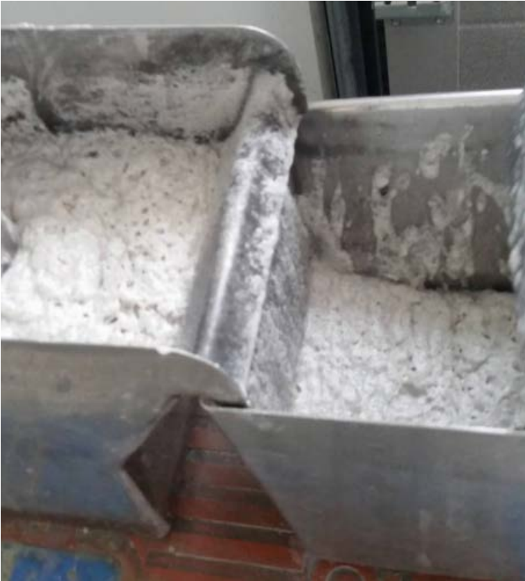
KUVA 28. Kokeiden A6 ja B6 vaahdonkeruun aikana syntynyt harmaa ja jäykkä vaahto
