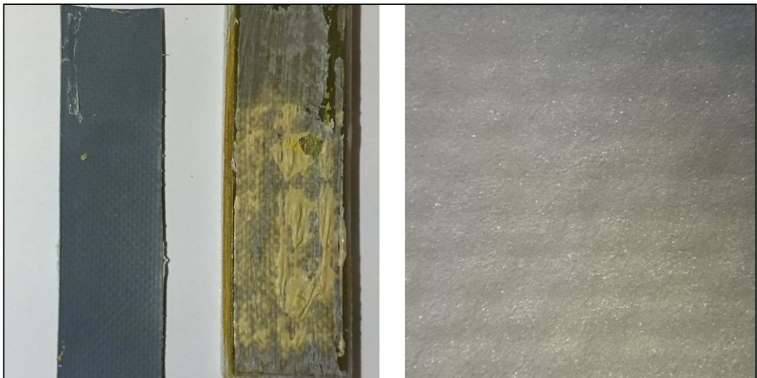
Kuva 26. Lämpötilan vaikutus-kokeiden murtumatyyppin muuttuminen adheesiomurtumaksi lämpötilan vaikutuksesta. Vasemmalta: murtunut kuitulujitekangas, kuitulujitemuovi sekä mikroskoopilla suurennettu kuitulujitekankaan murtumatyyppi (adheesiomurtuma).
