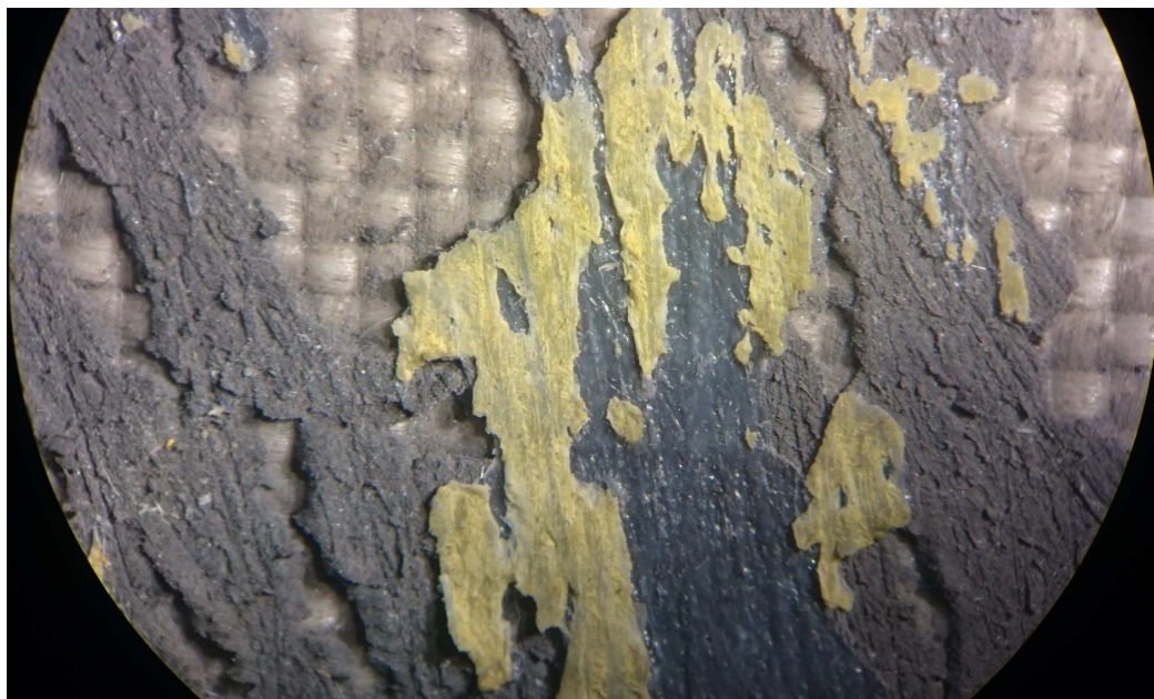
Kuva 9. Tyypillinen yhdistelmä-murtuma kuitulujitekankaassa suurennettuna mikroskoopilla.
