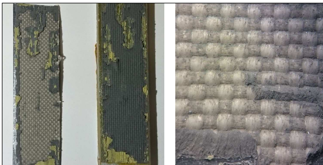
Kuva 22. Vasemmalta: murtunut kuitulujitekangas, kuitulujitemuovi sekä mikroskoopilla suurennettu kuitulujitekankaan päämurtumatyyppi. Koekappaleen päämurtumatyyppinä kuitukerrosmurtuma .
