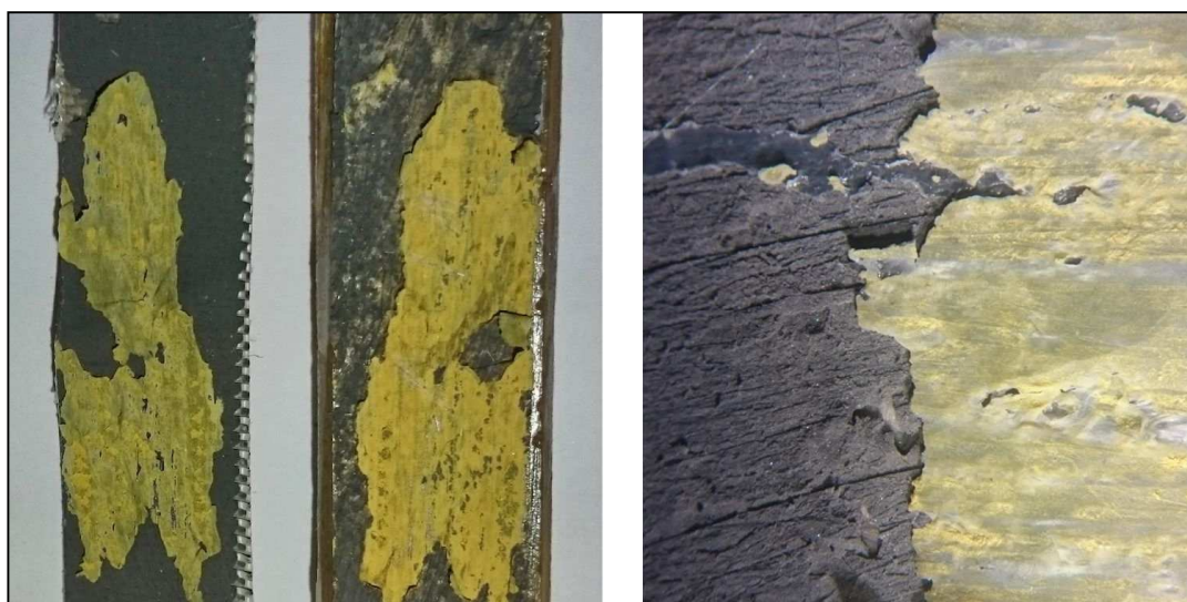
Kuva 28. Kovettumisajan vaikutus -kokeiden päämurtumatyyppin muuttuminen tartuntapohjuste-laminaattimurtumaksi kovettumisajan vaikutuksesta. Vasemmalta: murtunut kuitulujitekangas, kuitulujitemuovi sekä mikroskoopilla suurennettu kuitulujitekankaan päämurtumatyyppi (tartuntapohjuste-laminaattimurtuma).
