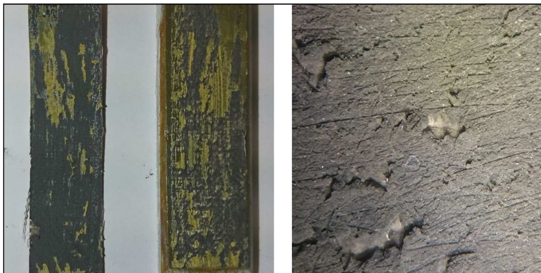
Kuva 21. Vasemmalta: murtunut kuitulujitekangas, kuitulujitemuovi sekä mikroskoopilla suurennettu kuitulujitekankaan päämurtumatyyppi. Koekappaleen päämurtumatyyppinä ohut kuitukerrosmurtuma .
