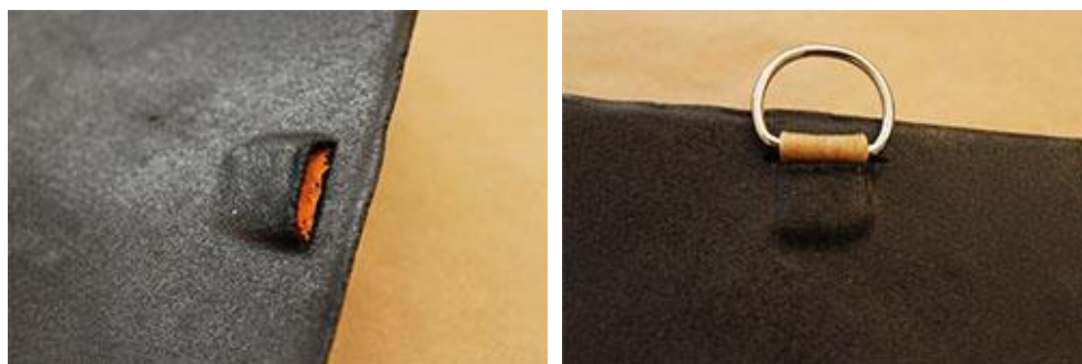
Kuva 33. Suojuksesta avattu aukko ja D-rengas lenkin kanssa upotettuna suojukseen. (Skinnari 2016)
