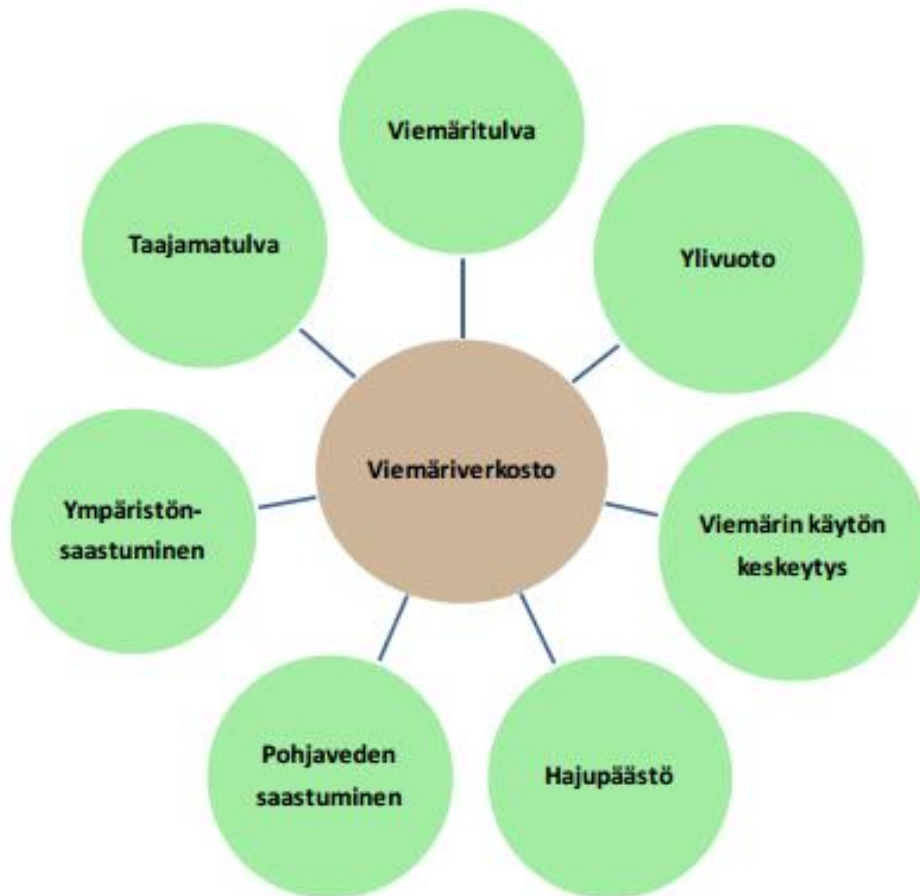
KUVA 4. Viemäriverkoston riskit /5, s. 42/
