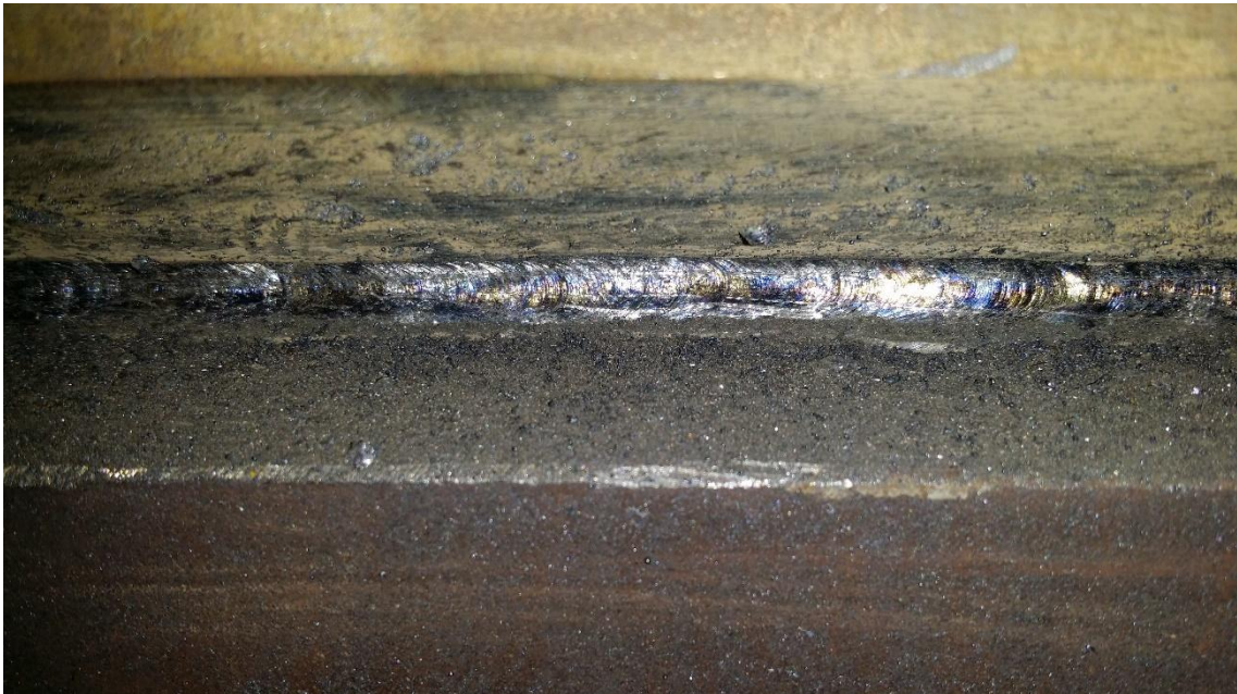
Kuva 6. Puikolla hitsattu juurisauma
