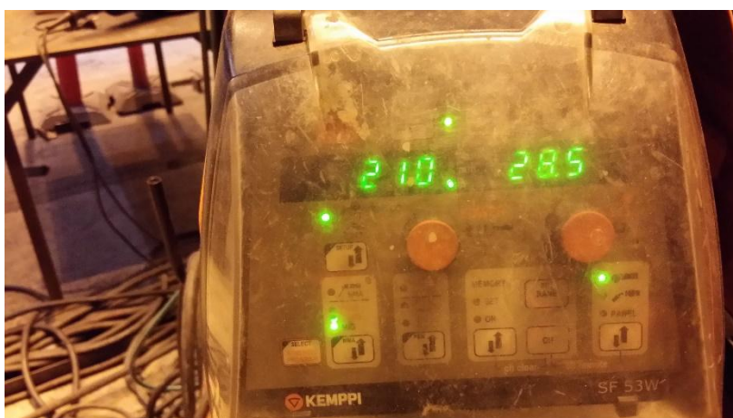
Kuva 12. Mig/Mag-hitsauskoneen arvot hitsauksen aikana.
