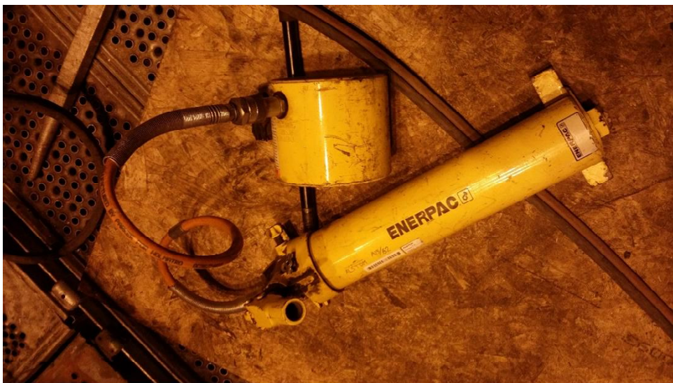
Kuva 11. Sauman kohdistukseen käytetty tunkki.
