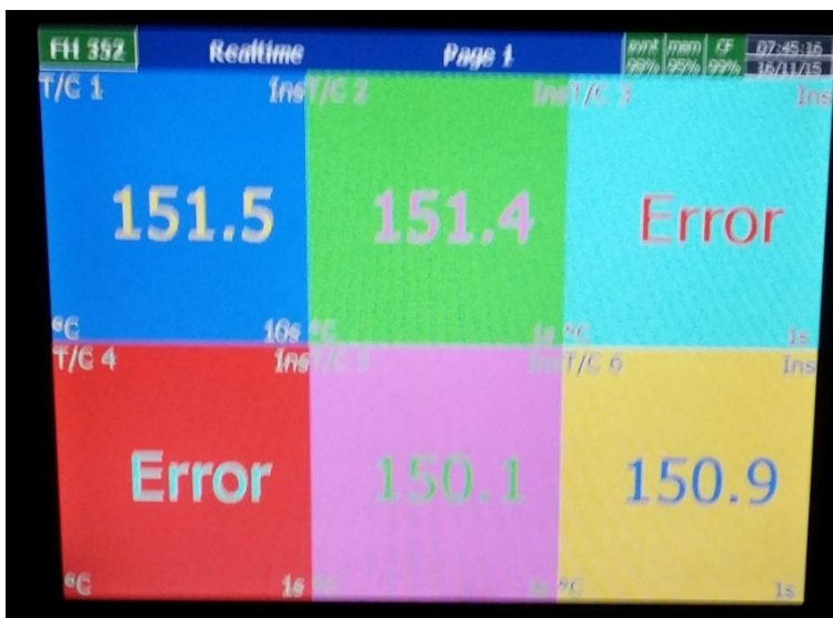
Kuva 14. Lämpövastuksien monitorointi hitsauksen aikana.
