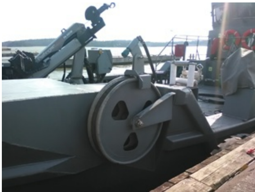
Kuva 11. Kaapelikissa sijaitsee kaapeliveneen vasemmassa partaassa. (Juho Tikka 2015)
