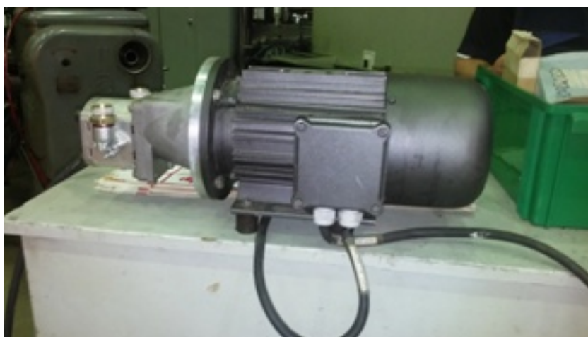
Kuva 16. Creusen Roermond sähkömoottori ja vanha hydraulipumppu irroitettuna kaapeliveneeltä Millog Oy:n verstaalla Turussa. (Juho Tikka 2015)
