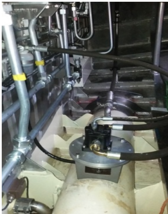
Kuva 7. Keulapotkuritunneli ja potkurin kannatinosa. (Juho Tikka 2015)
