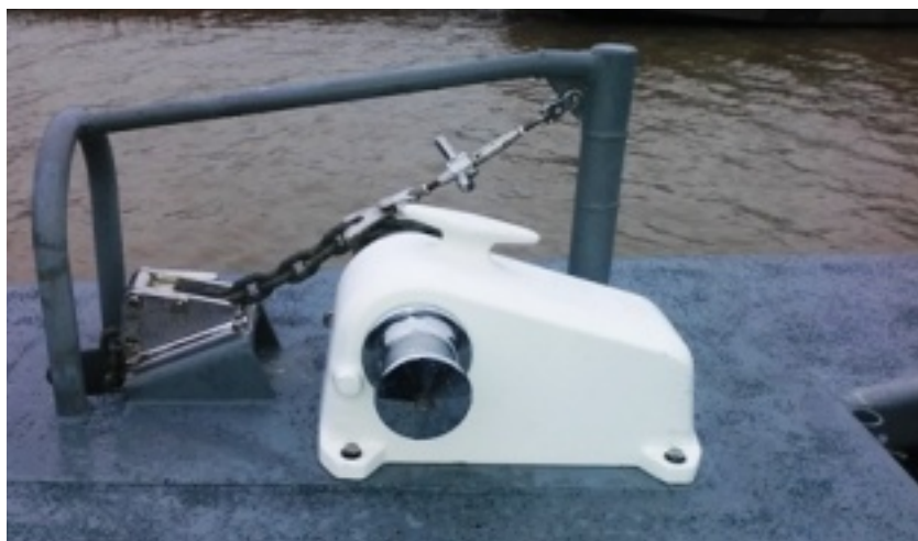
Kuva 9. Keulassa ankkuripelinä Muir HR 3500 Jaguar. (Juho Tikka 2015)
