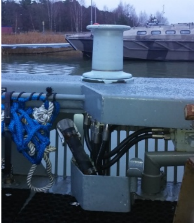
Kuva 5. Kapstaanit ovat kiinnitettyinä partaisiin molemmilla puolin alusta. (Juho Tikka 2015)
