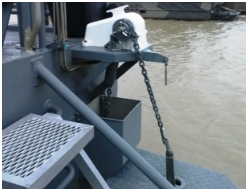
Kuva 10. Perässä ankkuripelinä Muir HR 2500 Cheetah. (Juho Tikka 2015)
