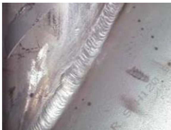
Figur 14 Detalj av svetsat område efter betning (Crookes. R., 2004, s.8).
