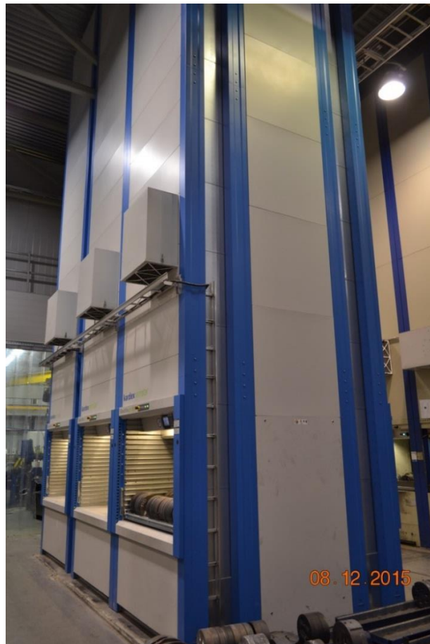
Kuvio 13. Mäkelä Alu Oy:n tuotannossa käytössä oleva Kardexin automaattivarastojärjestelmä.
