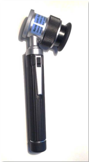
KUVA 5. Vedeneristyksen ainevahvuuden mittaamiseen käytettävä luuppi
