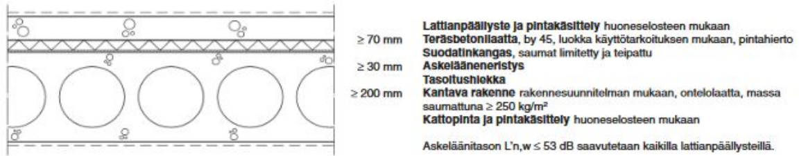
KUVA 8. Kelluva teräsbetonilaatta (RT 83-10902. 2007)
