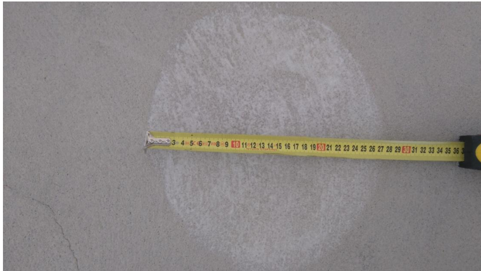
Kuva 16. Lasihelmikoe, lasihelmien levinneisyyden mittaus.
