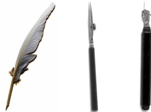
KUVA 4. Sulkakynä, vetopiirrin ja grafos-piirrin (Wikipedia 2016a)
