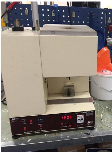
Figure 16. Mitaten Extrusion plastometer
