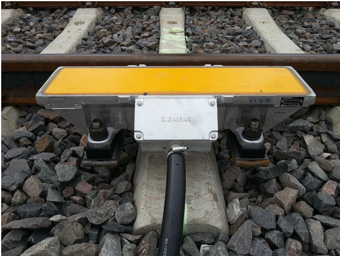
Kuva 12: PZB-sähkömagneetti raiteen vieressä (Lähde: Wikimedia/ACBahn)
