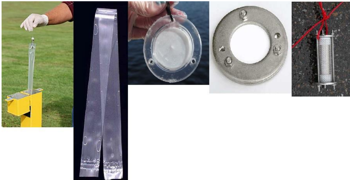
KUVA 6. Esiteltävät passiiviset näytteenottimet (kuvasuhteet eivät täsmää), vasemmalta oikealle: PDB, SPMD, Chemcatcher, POCIS ja Ceramic Dosimeter
