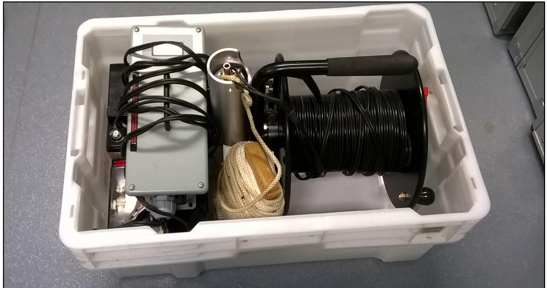
KUVA 3. Näytteenotossa käytettävä uppopumppuvälineistö (Kettunen 2016)
