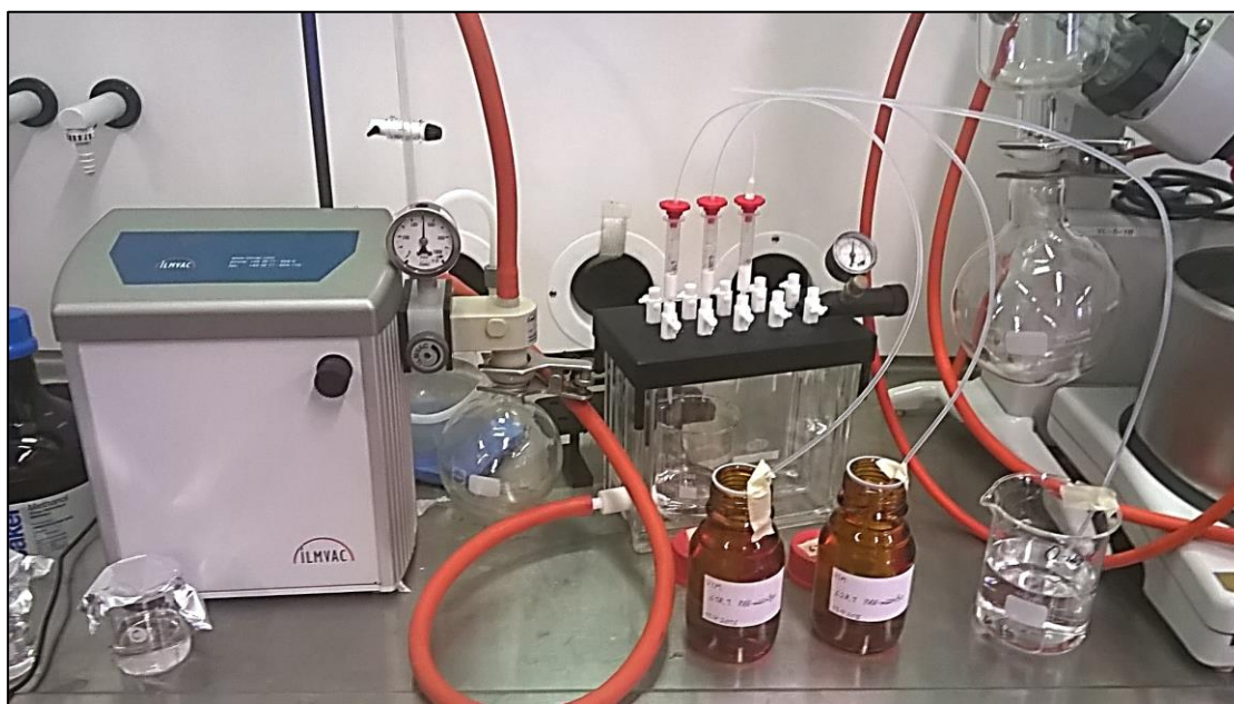
KUVA 13. Työssä käytetty imulaitteisto ja SPE-kolonnit (Kettunen 2016)
