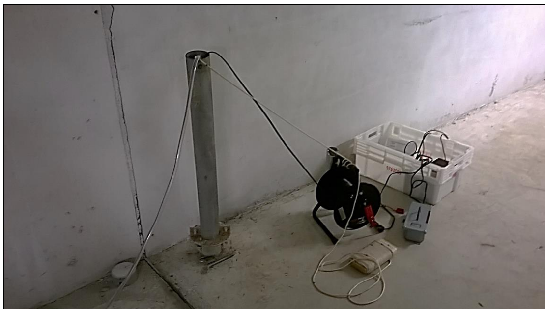
KUVA 12. Näytteenotto havaintoputkesta 62R (Kettunen 2016)
