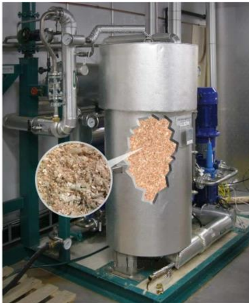
Kuva 3. Panostoiminen kuumavesiuutto. [5, s.4.]
