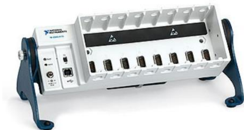
KUVA 37. cDAQ-9172 -kompaktipohja (National Instruments, CompactDAQ 2016)
