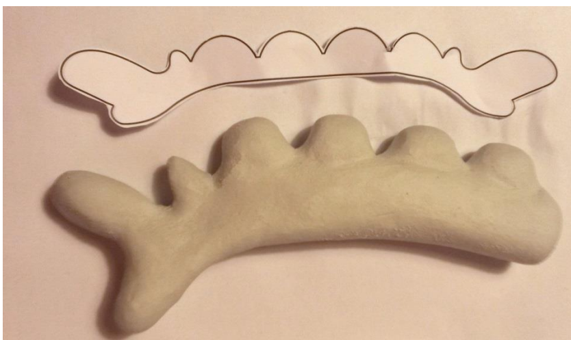
Kuva 14. Protomalli valmiina, vielä maalipintaa vailla ja apupiirroskuva auttamassa suhteessa 1:2 (Tevajärvi 2016).
