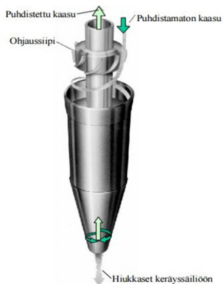
Kuvio 3. Vastavirtausykloni (Ohlström ym. 2015)
